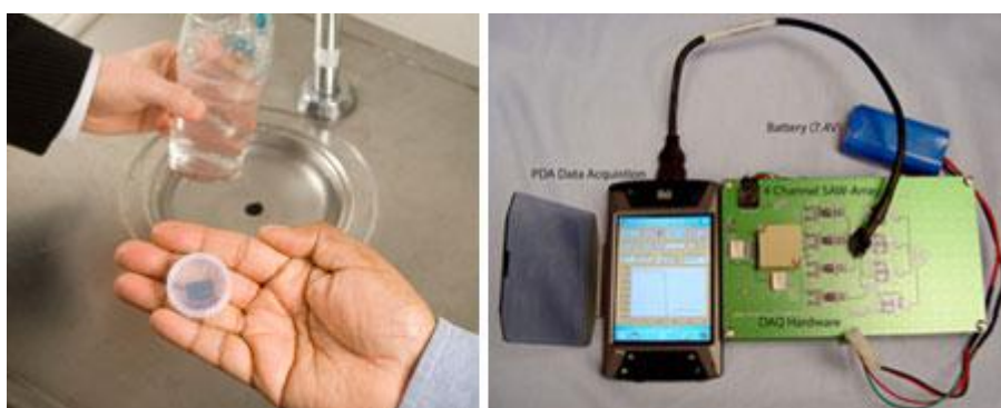
شکل ۴- نمونه هایی از حسگرهای زیستی. (چپ) "آزمایشگاه روی یک تراشه" یک حسگر زیستی مبتنی بر فناوری نانو است که آزمون هایی برای بیماری های عفونی و بیماری های ناشی از آلودگی آب آزمون می شود. (راست) حسگر زیستی موج آکواستیک قابل حمل با نیروی باطری که طیف گسترده ای از پاتوژن ها را در چند دقیقه شناسایی می کند.
