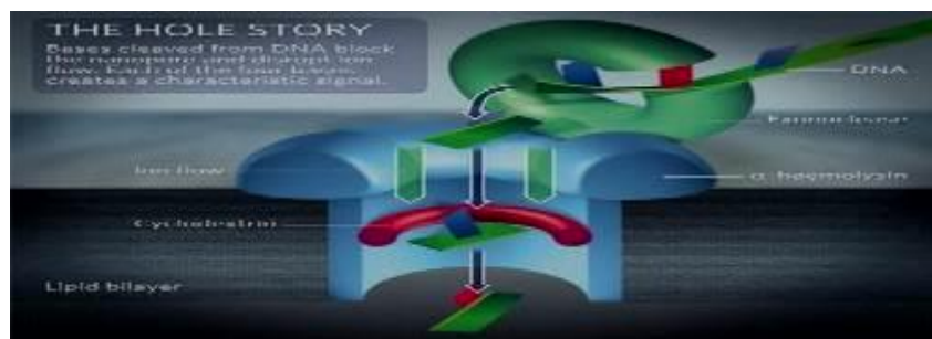
شکل ۲- آگزونوکلئاز (سبز) در دهانه نانوپور آلفا همولایزین (آبی). حلقه دکسترین (قرمز) باعث تنگ‌تر شدن کانال می‌شود (۱۸).
