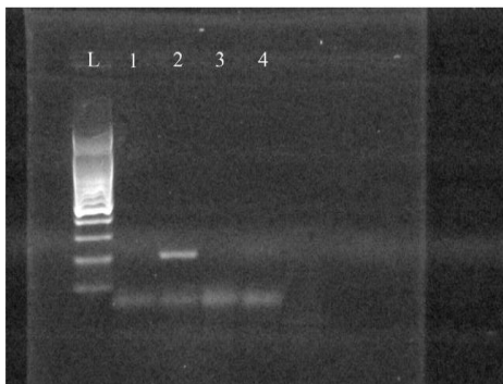
شکل ۲- باندهای حاصل از PCR دو نمونه کلزا با پرایمر پیشبر 35S CaMV. به ترتیب از چپ: L= مارکر 100 bp، ۱= کنترل منفی (باکتری E.coli)، ۲= کنترل مثبت (ERM 410)، ۳= نمونه کلزا زرفام، ۴= نمونه کلزا هیبرید هایولا ۶۰
