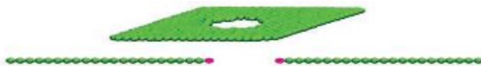
شکل ۷- ساختار گرافن، دوایر سبز اتم‌های کربن و دوایر قرمز کربن‌های واقع در دهانه نانوپور می‌باشند (۱۹).
