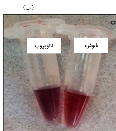
شکل ۲- الف) طیف جذبی پلاسمون های سطحی نانوذرات طلا (GNP) و نانوپروب سالمونلا (GNP-apt). ب) تفاوت رنگ نانوذرات طلا و نانوپروب سالمونلا در نور اتاق.
